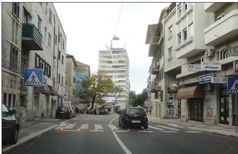
Slika 8. Pješački prijelaz s ugrađenim bljeskalicama u kolniku i većim dimenzijama obostrano postavljenih prometnih znakova C02 - „obilježeni pješački prijelaz“
